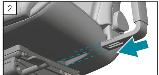
3. Nutze den Inbusschlüssel und eine der beiden beigelegten Schrauben mit Unterlegscheibe, um die Armlehne an dem Sitzkissen zu befestigen. Platziere dazu zunächst die Unterlegscheibe in die Nut der Armlehne. Schiebe dann von unten die Schraube hindurch in die vorgesehene Bohrung im Sitzkissen. Achte darauf, dass du die Schraube mit dem Inbusschlüssel gut festziehst. [3]
